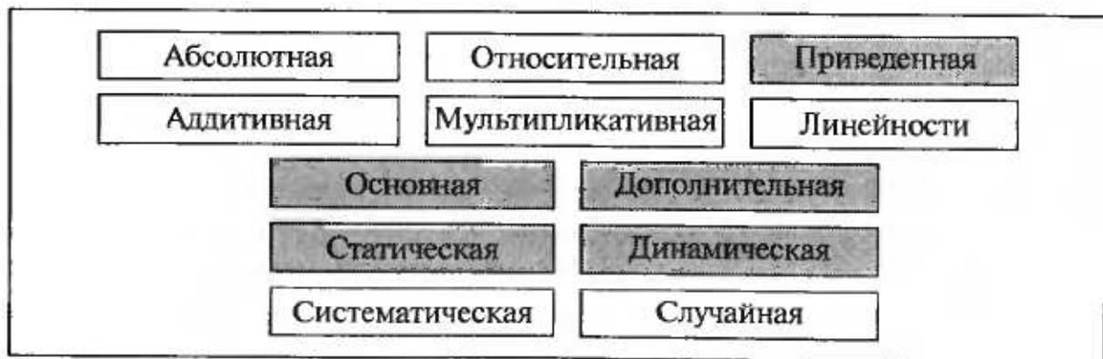
Рис. 1.9. Упрощенная классификация погрешностей средств измерений
