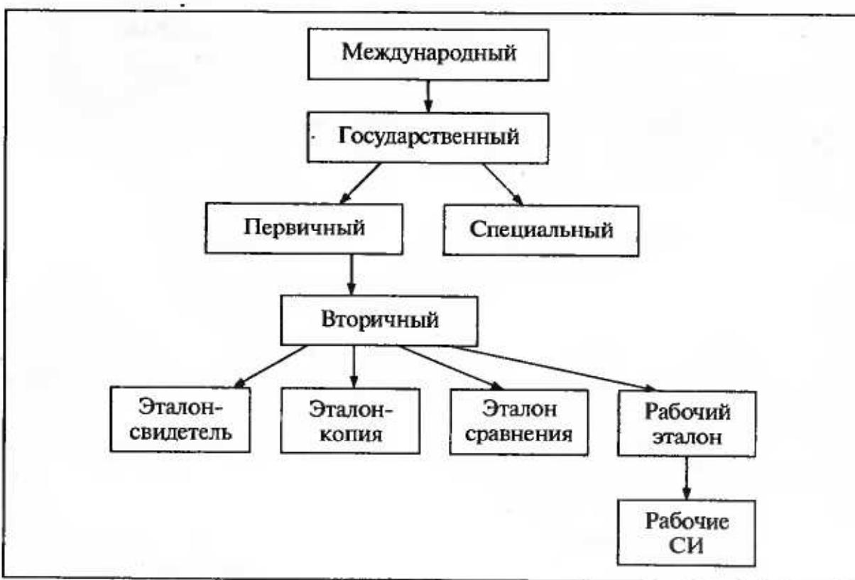
Рис. 1.6. Схема передачи размера единицы
