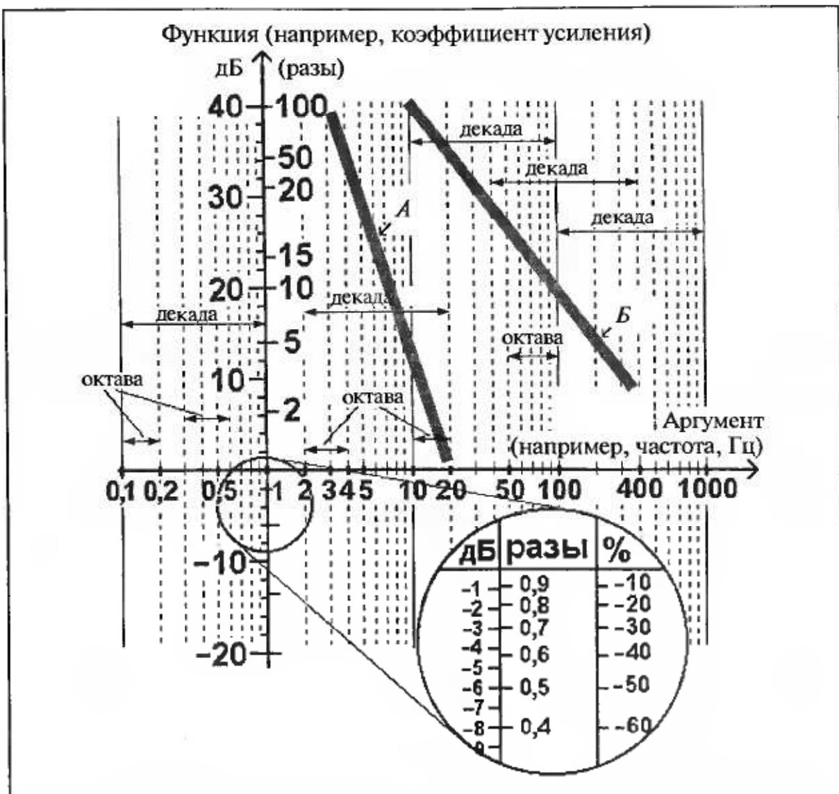
Рис. 1.5. Графическая иллюстрация относительных и логарифмических величин
