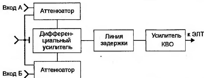
Рис. 8.7. Входные цепи двухканального осциллографа с дифференциальным усилителем
