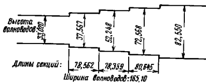
Рис. 6.08.2. Геометрические размеры (в мм) трансформатора, рассмотренного в примере 1 § 6.08, с коррекцией длин секций, учитывающей емкости сочленений
