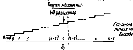
Рис. 6.14.1. К определению квс, наблюдаемых внутри отдельных секций (резонаторов) трансформатора или фильтра.
