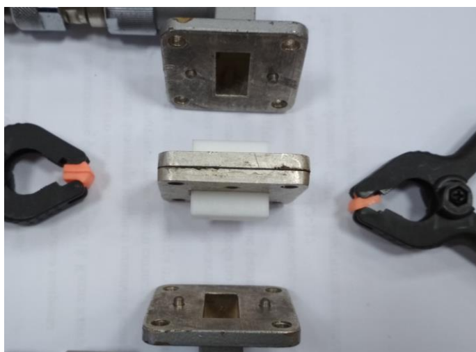
Рис. 8.13. Измерительная ячейка с образцом диэлектрика
