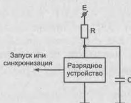
Рис. 1.21. Обобщенная схема генератора развертки
