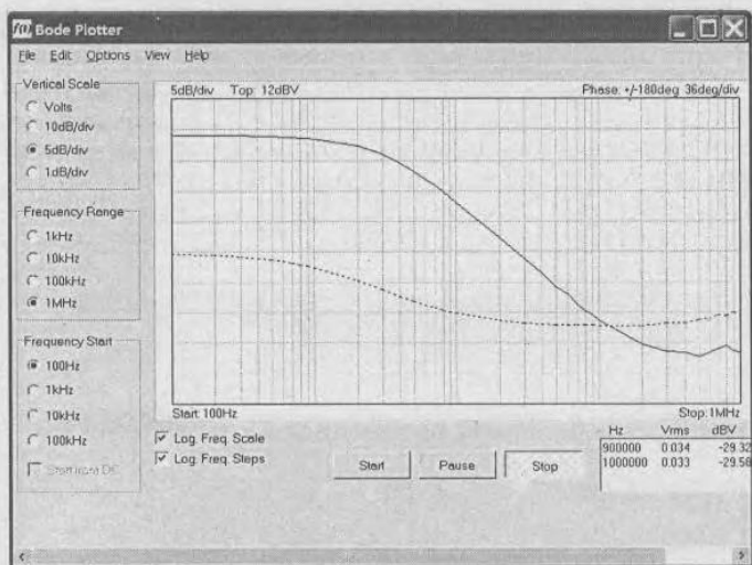
Рис. 6.46. Построение АЧХ и ФЧХ дифференцирующей RC-цепи
