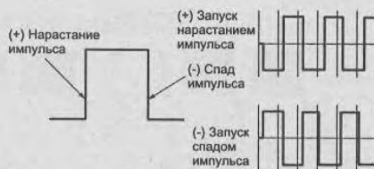
Рис. 5.16. Влияние полярности запуска развертки при просмотре прямоугольных импульсов
