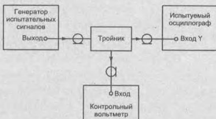
Рис. 5.13. Измерительная схема для снятия АЧХ осциллографа
