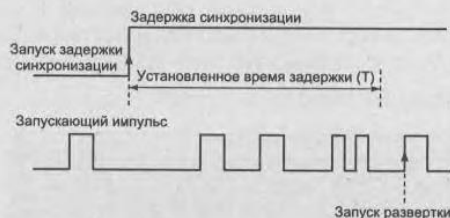
Рис. 5.65. Временные диаграммы запуска развертки по заданному времени задержки
