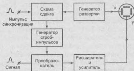
Рис. 3.3. Функциональная схема стробоскопического осциллографа
