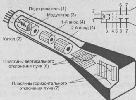
Рис. 1.6. Осциллографическая ЭЛТ с электростатическим отклонением и ее обозначение
