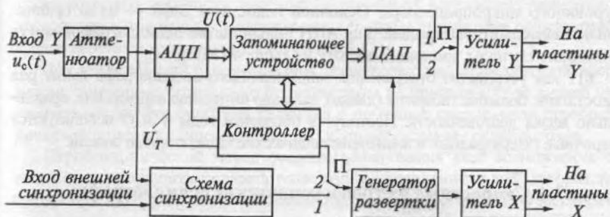
Рис. 7.12. Структурная схема запоминающего цифрового осциллографа
