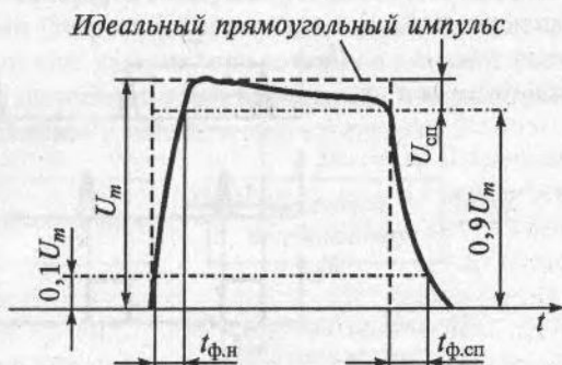
Рис. 6.10. Параметры реального прямоугольного импульса
