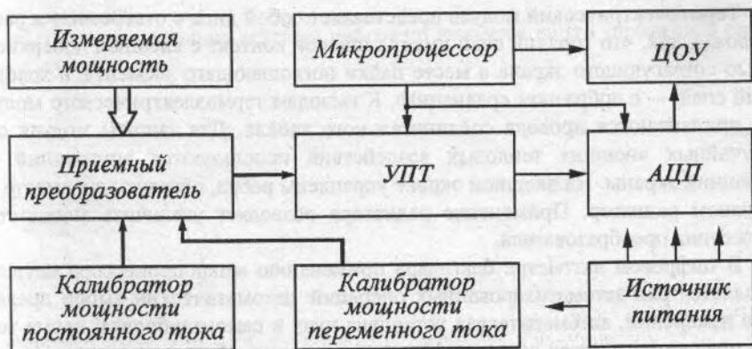
Рис. 10.10. Упрощенная структурная схема цифрового ваттметра
