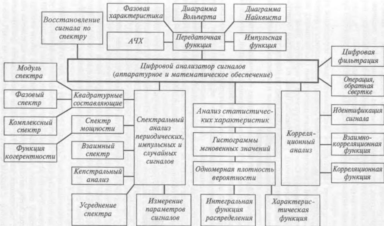
Рис. 11.10. Функциональные возможности современного цифрового анализатора спектра
