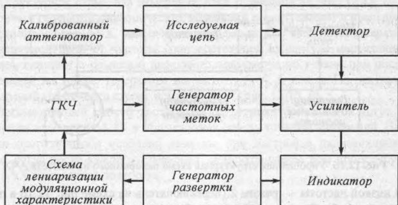
Рис. 12.18. Обобщенная структурная схема панорамного измерителя АЧХ
