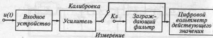
Рис. 11.15. Упрощенная структурная схема аналого-цифрового измерителя нелинейных искажений
