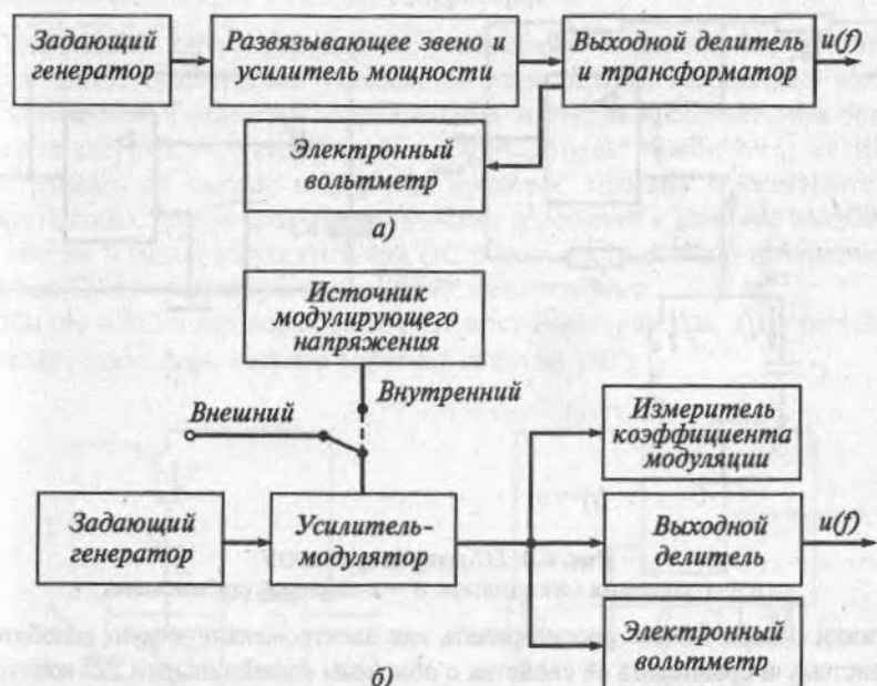
Рис. 6.2. Обобщенные структурные измерительные схемы: а — генератора сигнала; б — генератора стандартных сигналов
