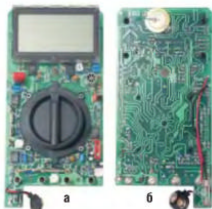
Рис.3. Печатная плата прибора (а - лицевая, б - обратная сторона)
