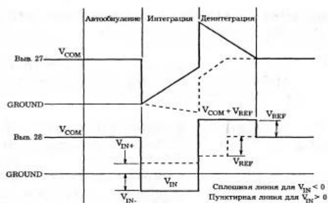
Рис. 4.2. Второй вариант контрольной осциллограммы на выв. 27, 28 АЦП
