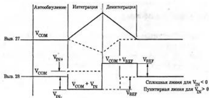
Рис. 4.1. Вариант контрольной осциллограммы на выв. 27, 28 АЦП
